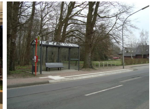
Grundausstattung einer Fahrbahnrandhaltestelle (Kreis Osnabrück)
